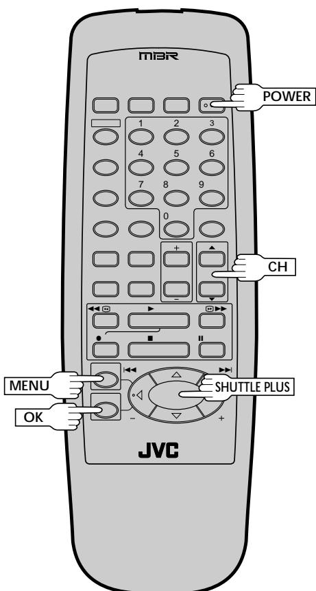
Le système de programmation de la minuterie VCR Plus+ élimine le besoin de rentrer les données pour le canal, la date, l'heure de début et de fin lors du réglage de la fonction d'enregistrement par minuterie. Tapez simplement le numéro PlusCode pour le programme que vous voulez enregistrer (indiqué dans la plupart des guides TV) et la minuterie du magnétoscope est programmée automatiquement.
