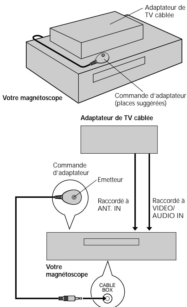
Cette procédure est nécessaire si vous recevez vos canaux TV à travers un adaptateur de TV câblée (décodeur). La commande d'adaptateur de TV câblée permet au magnétoscope de commuter automatiquement les canaux de l'adaptateur de TV câblée pendant l'enregistrement par minuterie. Elle fonctionne pour l'enregistrement de spectacles qui ont été programmés en utilisant la programmation VCR Plus+ (p. 38) ou sur écran (pg. 40).
